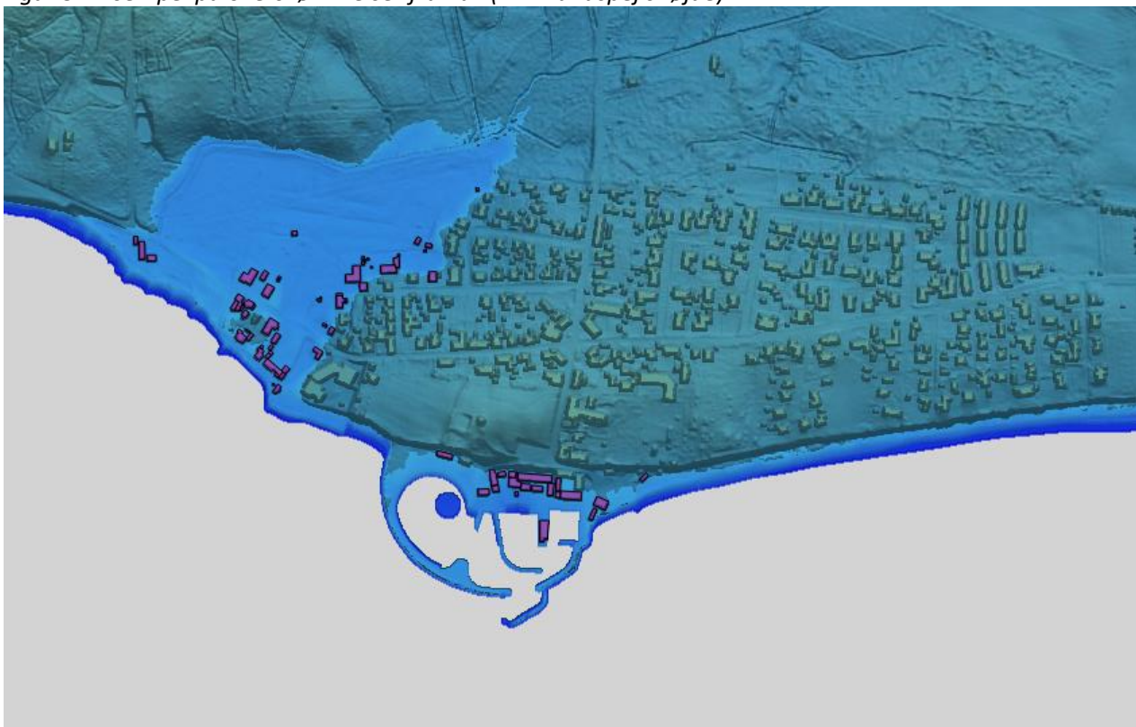
Figur 3: Eksempel på oversvømmelser fra hav (2 m vandspejlshøjde)
