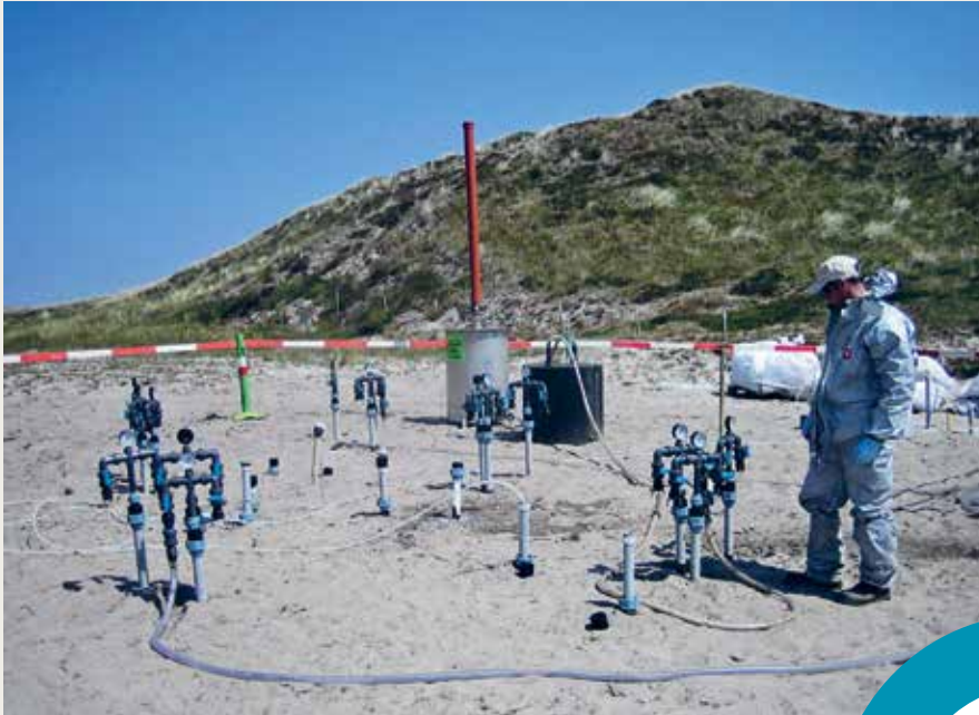
Pilotforsøg med kemisk oxidation, hvor der i et testfelt blev tilført kemikalier med henblik på oprensning af grundvandet i Kærgård Klitplantage.
