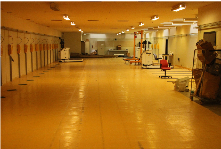
Foto 3: Ladestationer og reparation/vedligeholdsplads for AGV'er
