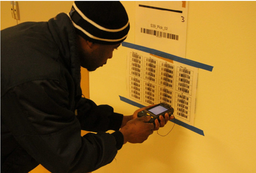
Foto 6: Stregkodeaflysning til bestemmelse af destination for AGV
