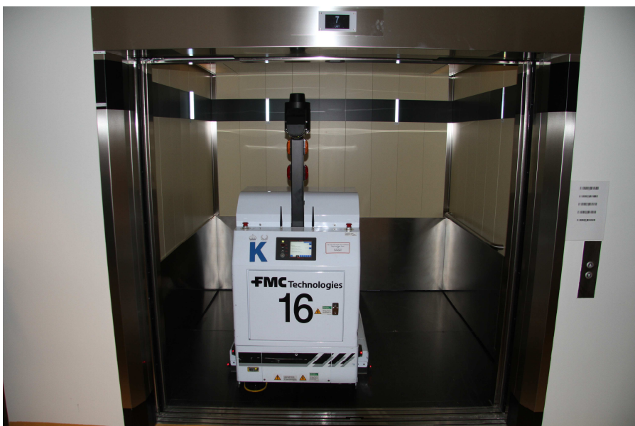
Foto 11: AGV tager selv elevator ved forsyningsstation
