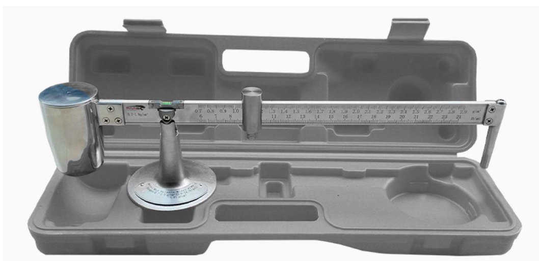
Figur 8-1 Vægt til bestemmelse af densitet af grout
