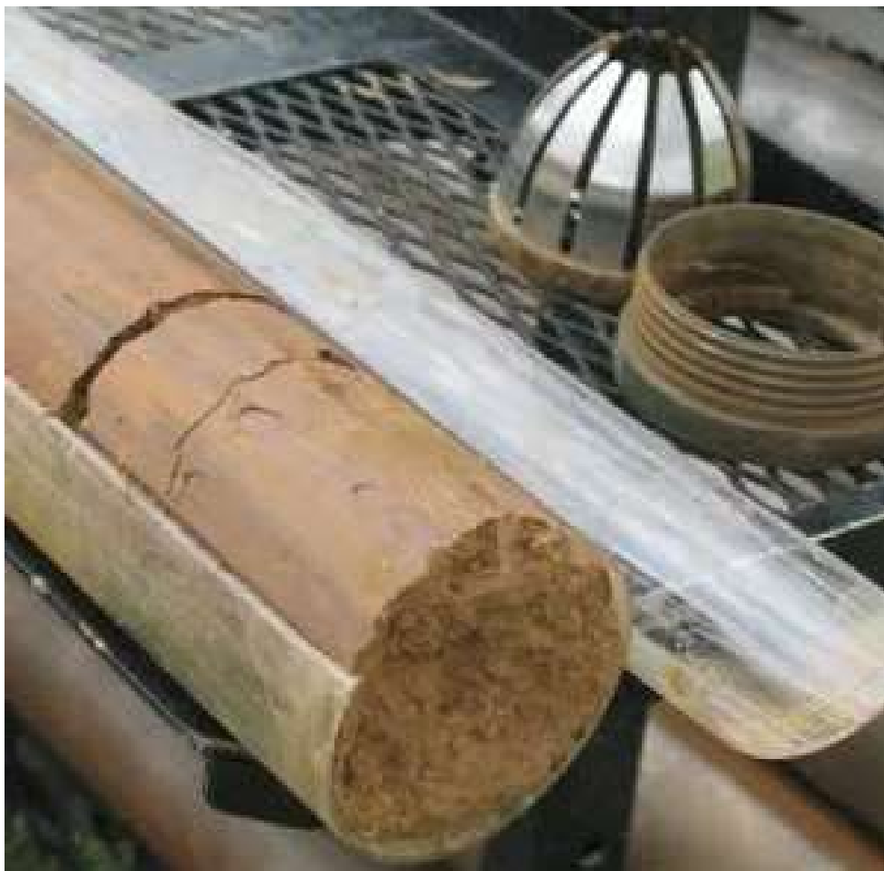
Figur 6-2 Eksempel på jordkerne i åbnet liner og kerne skåret op til bedømmelse.
