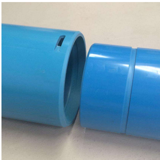
Figur 7-3 PVC RSC-samling med løs muffe, O-ring, tætningsbånd og udfræsning til låsebånd.
